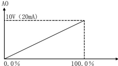
图 5-8 给定量与模拟输出对应关系
