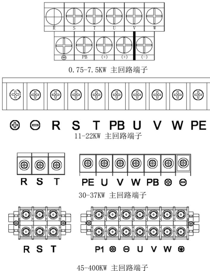
图 3-3 控制回路端子排和主回路端子排的排列
