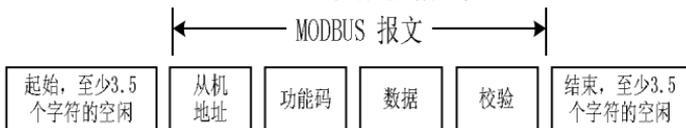
一个帧的信息必须以一个连续的数据流进行传输，如果整个帧传输结束前有超过 1.5 个字节的间隔时间，接收设备将清除这些不完整的信息，并错误认为随后一个字节是新一帧的地址域部分，同样的，如果一个新帧的开始与前一个帧的间隔时间小于 3.5 个字节时间，接收设备将认为它是前一帧的继续，由于帧的错乱，最终 CRC 校验值不正确，导致通讯故障。
