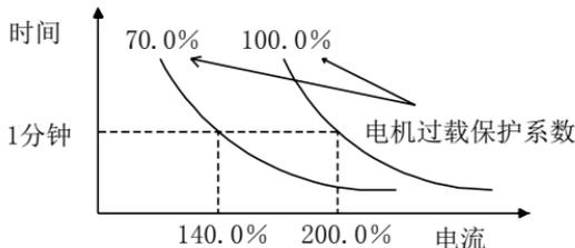
图 5-19 电机过载保护系数设定
