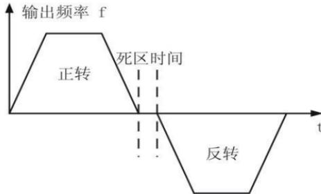
图 5-10 正反转死区时间示意图
