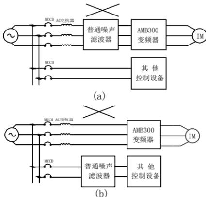
图 3-6 噪声滤波器的错误设置
