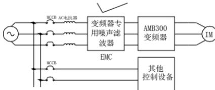
图 3-5 噪声滤波器的正确设置
