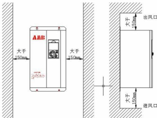
图 2-4 AMB300 变频器安装方向和空间
