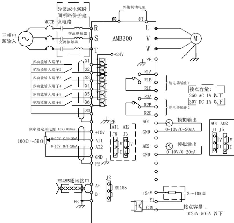
图 3-13 控制回路端子连接图
