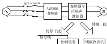
图 3-7 输出侧噪声滤波器的安装
