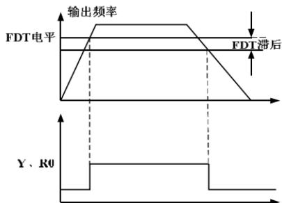
图 5-16 FDT 电平示意图
