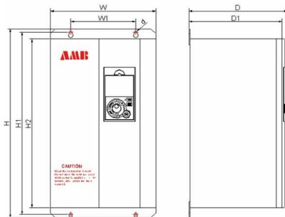
11kW-132kW 外形尺寸和安装尺寸（金属结构）
