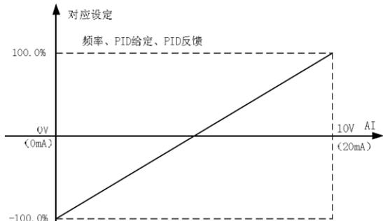
图 5-7 模拟给定与设定量的对应关系
