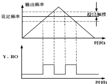
图 5-17 频率到达检出幅值示意图
