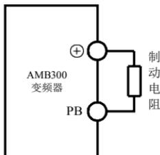
图 9-1 制动电阻的安装
