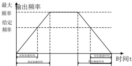
图 5-1 加减速时间示意图
